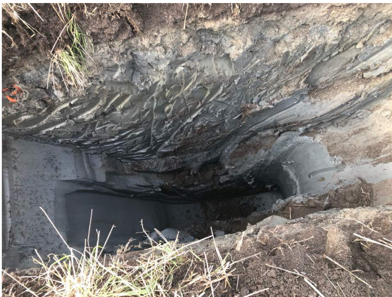
Figur 4. Bildet viser begynnelsen av undersøkelsesgrøften, man kan tydelig observerer de øverste 50 cm med matjord og den lyse intervallet under med tørreskorpeleire. Under dette er leiren homogen og middels fast til middels bløt
